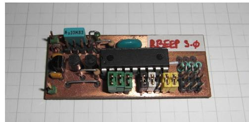
Abbildung 2: Aufgebauter Prototyp des Roger-Beeps, noch ohne integrierter Anpassung des Ausgangspegels. Die Pullup-Widerstände sind auf der Unterseite in SMD ausgeführt, da die Platine noch vom Vorgänger übernommen wurde.
